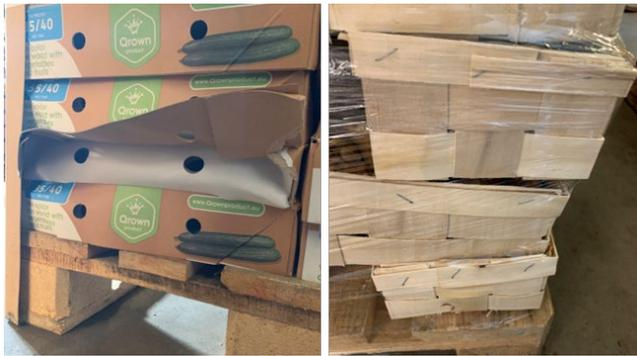
*Abbildung 10 Beispielhafte Schadensbilder für fehlende Stabilität (links) und fehlende modulare Abstimmung (rechts)*
