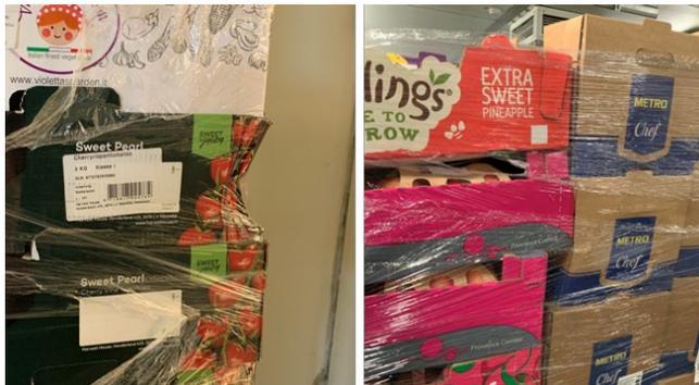
*Abbildung 11: Beispielhafte Schadensbilder für äußere Einflüsse (links) und unzureichende Ladeeinheitensicherung (rechts)*
